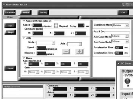
一般運動測試，jog運轉，歸原點，I/O狀態顯示
